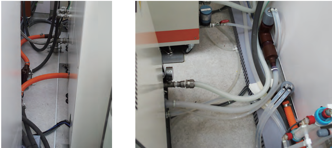
図4 フレキシブルチューブの採用 (著者作成)
