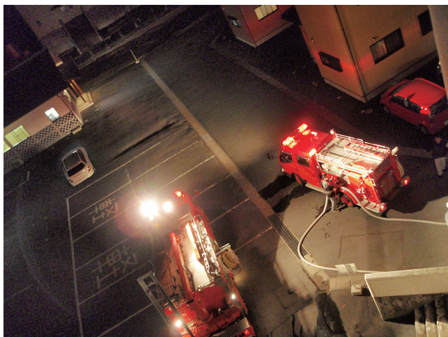
図 7 東日本大震災時の給水活動-2 自衛隊の給水タンクから消防ポンプ車で揚水 2011年3月11日21時19分
