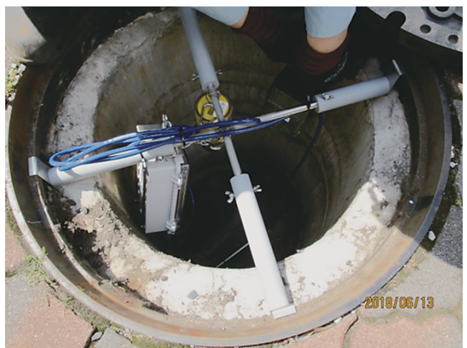
図4 pH計を用いた現地調査
